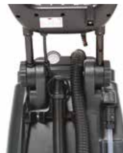
Manguera de desagüe para facilitar el vaciado
