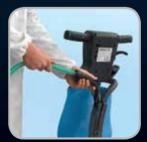
Limpieza periódica del tubo de la boquilla de aspiración, para garantizar una aspiración eficiente
